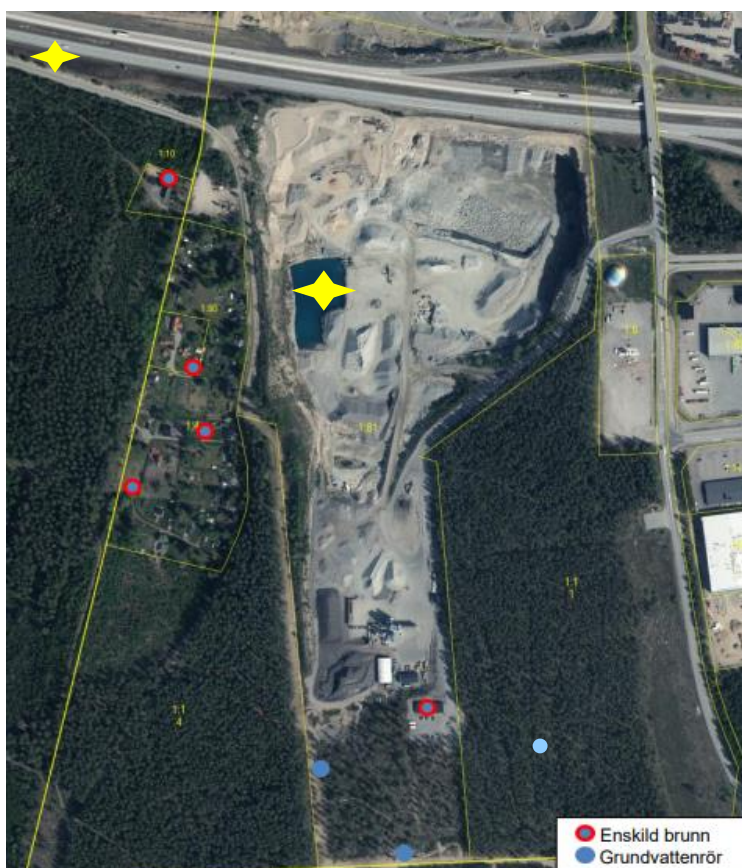
Figur 3. Mätpunkter för kontroll av grundvattennivåer, blå cirklar och vattenkvalitet, röda cirklar vid Kjula syd. Gula stjärnor markerar var ytvattenkvalitet kontrolleras.
