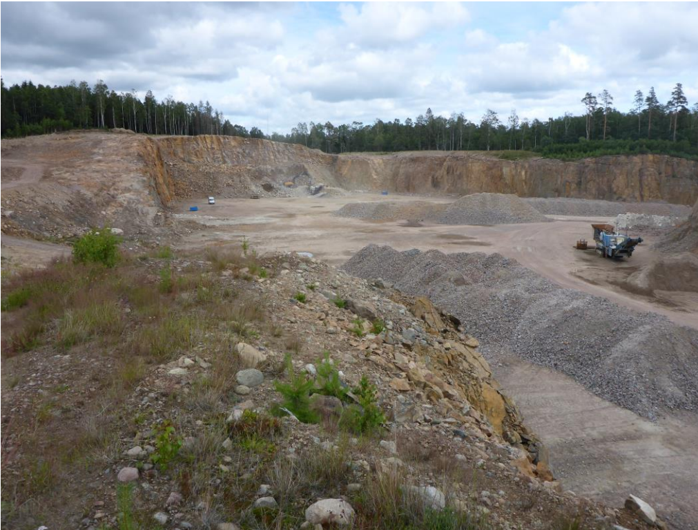
Figur 4 Exempelbild på bergtäkt. Stora mängder krossat bergmaterial täcker ytorna och fördröjer således avrinningen.
